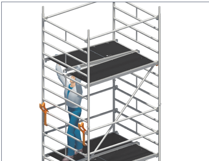
3. Diagonalen, Belagbrücke und Durchstiegsbrücke einsetzen.
